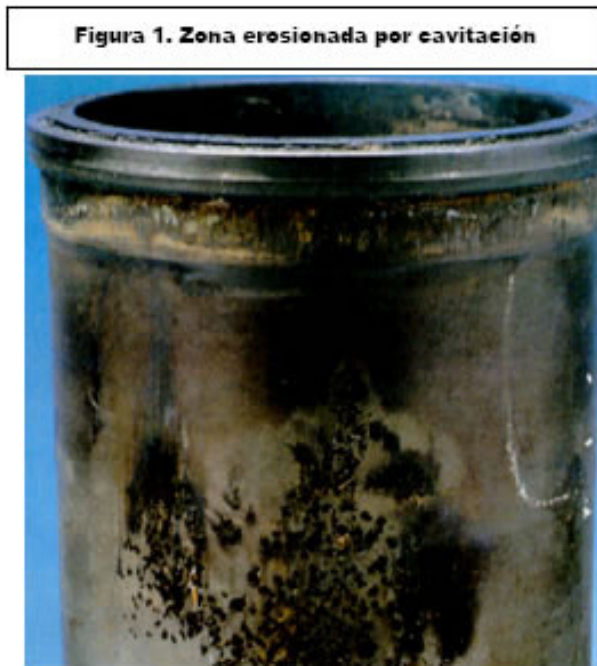
Figura 1. Zona erosionada por cavitación
